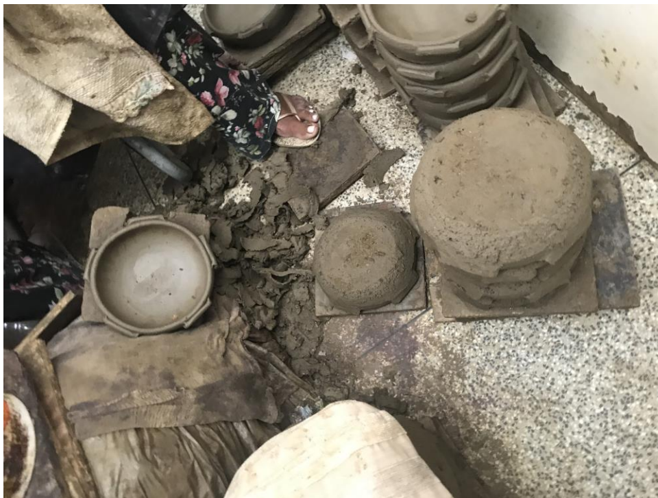
Anexo 17 - Panelas sendo moldadas, no estágio inicial do ofício. Vários barros em excesso retirados do exterior da panela, que vai tomando formato arredondado.
