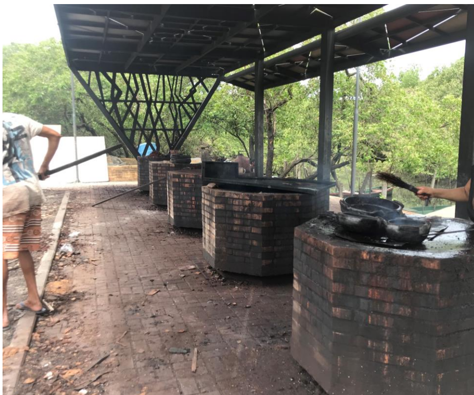
Anexo 37 – bancadas fornecidas pela Prefeitura de Vitória para a queima e selagem das panelas.
