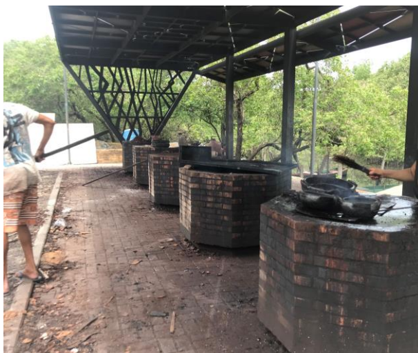
Figura 15: balcões adaptados, fornecidos pela Prefeitura de Vitória/ES, onde realizam a queima e a selagem com a pintura obtida através do tanino.
