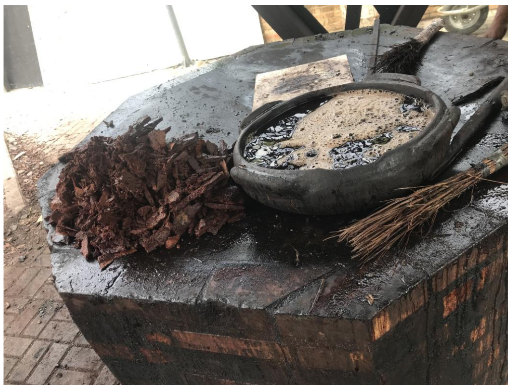
Anexo 48 – Lascas do Mangue vermelho ao lado da panela contendo o sumo líquido do tanino, corante utilizado para a selagem e cor preta da panela.
