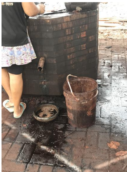
Figura 16: os balcões são adaptados com um mecanismo que possibilita a reutilização do tanino, utilizado para a selagem e tintura da panela.
