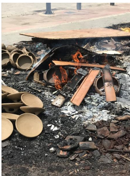
Figura 19: panelas “cruas”, sendo queimadas a céu aberto.
