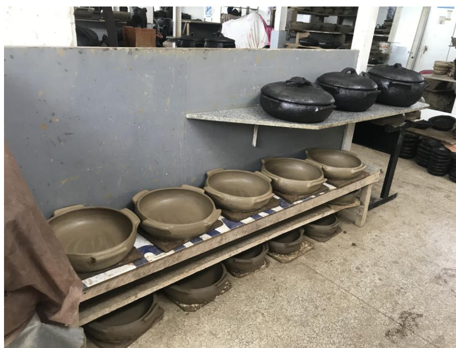
Anexo 10 - Panelas em três estágios diferentes: ao chão, recém moldadas e úmidas. No meio, secas e aguardando a queima, selagem e tintura. Acima, já prontas para a venda, após receberem a queima, selagem e tintura com o tanino.
