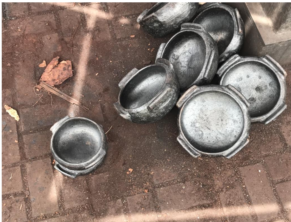
Anexo 43 – Pannels seladas e finalizada, prontas para a venda. Ainda no local de queima.
